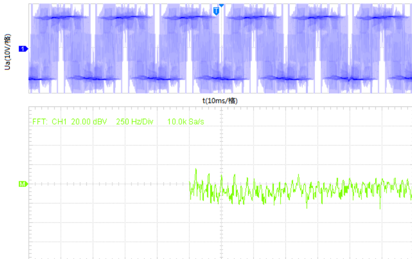
加入滤波器之前的差模电压FFT
