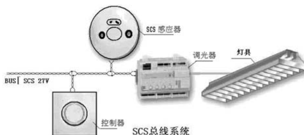
(b) 为 SCS 总线系统构建示意框图
