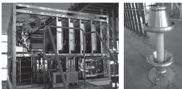
图10 脉冲电源装置实物及高压测量仪器图
