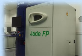
X-RAY检查内部气洞
