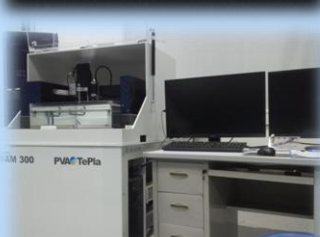
超声检查内部分层
