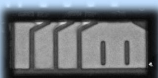
X-RAY检查内部气洞
