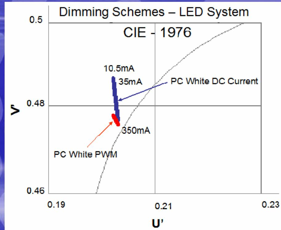
比较模拟调光和PWM调光方法在光颜色变化的差别
